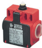
Serie 96/00 Koncový spínač BI 2 pro monitorování polohy šoupěte s nestoupavým vřetenem Na seznamu UL
