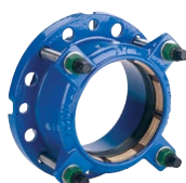
Série 623 Obj. č. 9.5.2 UNI plus přírubový adaptér pro PE a PVC potrubí Těsnění s jištěním proti vytržení Tvárná litina DN 40-300
