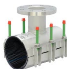
Série 729/32 Obj. č. 8.2.5 NERA navrtávací pas Dvojitě upnutý, odbočka s přírubou Nerezová ocel AISI 304 nebo AISI 316 NBR nebo EPDM pryž
