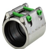
Série 745/20 Repico® posuvná spojka Univerzální pro všechny druhy potrubí Těsnění bez jištění proti vytržení Nerezová ocel AISI 316 Těsnění NBR nebo EPDM DN 15-600
