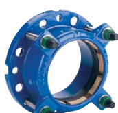
Série 623 Obj. č. 9.5.2 UNI plus přírubový adaptér pro PE a PVC potrubí Těsnění s jištěním proti vytržení Tvárná litina DN 40-300
