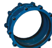
Obj. č. 9.2.1 Spojka na potrubí různého materiálu a profilu Možnost vyosení +/- 4° Velká tolerance na profilu potrubí. Celolitínové provedení. Epoxidová protikoroziní ochrana
