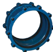
Obj. č. 9.2.3 Redukovaná spojka na potrubí různého materiálu a profilu Možnost vyosení +/- 4° Velká tolerance na profilu potrubí. Celolitínové provedení. Epoxidová protikoroziní ochrana
