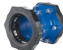
Série 05 Obj. č. 9.1.4/9.1.5 KOMBI příruba s těsněním pro PVC, ocelové nebo GGG Těsnění bez jištění proti vytržení Tvárná litina DN 50-600
