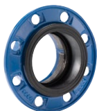
Série 05 Obj. č. 9.1.2/9.1.3 KOMBI příruba s těsněním pro PE, PVC nebo GGG potrubí Těsnění s jištěním proti vytržení Tvárná litina DN 50-300
