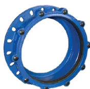
Obj. č. 9.2.2 Příruba na potrubí různého materiálu a profilu Možnost vyosení +/- 4° Velká tolerance na profilu potrubí. Celolitínové provedení. Epoxidová protikoroziní ochrana.
