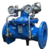
AVK Automatický kontrolní ventil Redukční ventil obj.č.13.1 série 859/000 Redukuje vstupní tlak na konstantní výstupní tlak Automaticky se řídí tlakovými poměry v síti, nepotřebuje zdroj energie
